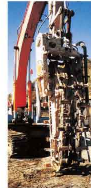
【トレンチャー式攪拌機】
