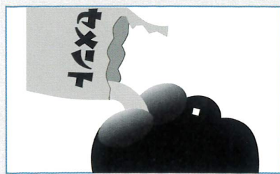
(2) MT 処理土をセメントや石灰等で改良する
