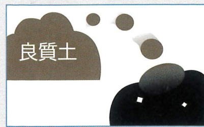
(3) MT 処理土に良質土を混合する
